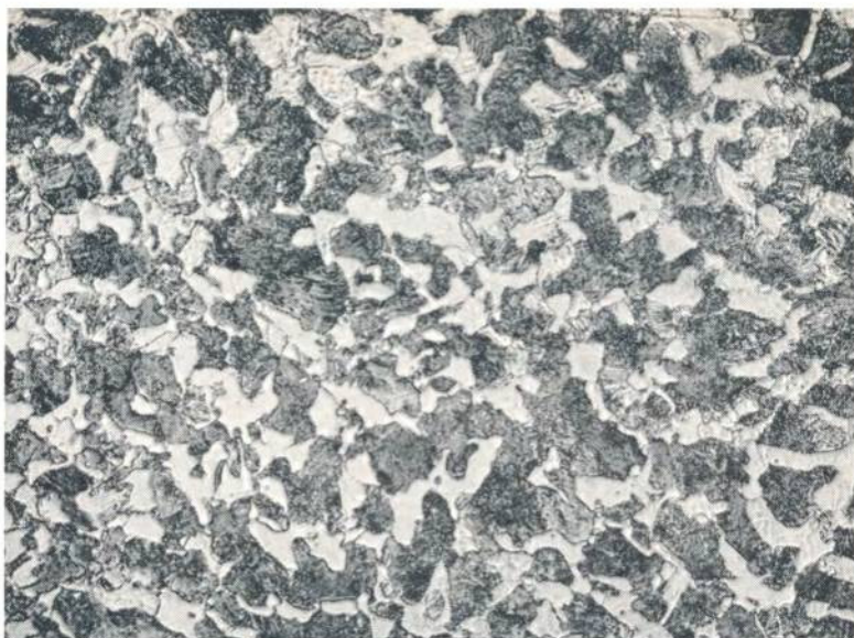
Фігура 1. Мікрографія нормалізованої сталі (0,46%С, 0,70—1,00%Мn). Ферит — білий, перліт — в пластинках. Побільшення 500 X. (Фото: С.І.М.А. — Сен Дізьє).
