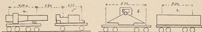
Рис. 3. 420 мм. гавбиця в русі: а) тіло гавбиці, б) моторовий віз, в) лафет і г) матеріали.
