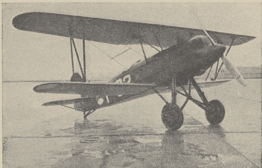
Мал. 5. Модерний літак-нищитель голянської продукції Фоккер D. XVII. Одно-особовий; мотор Іспано-Сюїза 12Х у 650 кін. сил; найбільша швидкість 350 кл./год.; набирає висоту 5000 метр. у 7,4 хв.; дах 9600 мтр.
