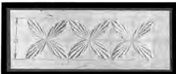
**Закруглювання різцем.** Способ заокруглювання опуклої лінії носиком різця до себе показаний на мал. 92-а. Слід намагатися, щоб носик різця пливко огинав кривину лінії і безперервно знімав фаску, поки лінія не скінчиться зовсім або різання перейде від способу «за верствою» на спосіб «проти верстви». Тоді носиком різця знімають фаску від себе способом, показаним на мал. 92-б.
