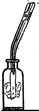
Мал. 165. Оксидация амоніаку при наявності каталізатора — платини.
