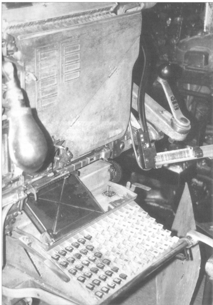
Лінотип — машина на якій проводилися набори тексту.
