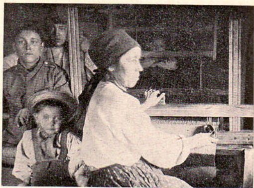
Лемка ткає полотно, в правій руці держить човник, а лівою шпулячкою рівнає основу полотна.
