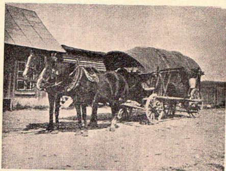
Мазярський віз із кіньми з Лосього, коло Горлиць. Коні в шкур'яних, сильних хомутах із каришками. Віз критий на ліскових каблуках грубим полотном.
